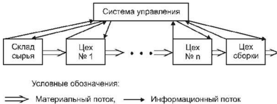
Рисунок 4 - Принципиальная схема толкающей системы управления материальным потоком в рамках внутрипроизводственной логистической системы
